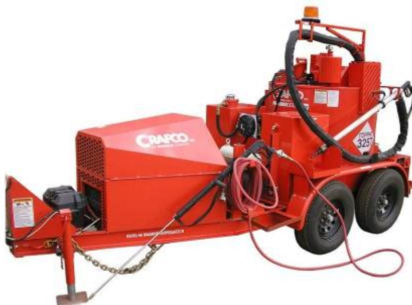
Время подготовки установки к работе составляет всего 45 минут. Отсутствуют клапаны, мало движущихся частей. Нет линий, находящихся под постоянным давлением, это способствует более эффективной эксплуатации машин, которые в настоящее время являются лучшими в отрасли, заслужив репутацию наиболее безопасных, простых и экономичных машин.
