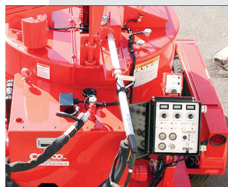
Блок управления расположен в безопасной зоне
