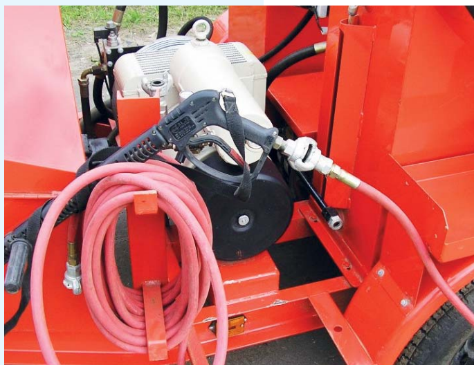
Компрессор используется только для подключения теплового копья и дополнительного оборудования
